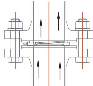
\*En tuberías horizontales la posición correcta de la válvula se consigue colocando el cáncamo en la parte superior y en vertical.
