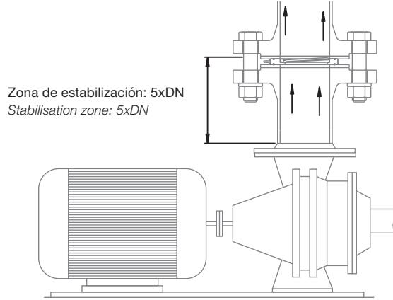
En caso de que no sea posible seguir estas recomendaciones en la instalación, asegurarse de que el fluido a la entrada de la válvula es estable. Con ello se logrará una mejora en el funcionamiento y en la duración de la válvula.
